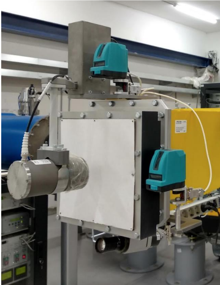
Цилиндр Фарадея, по которому проводилась внешняя калибровка
